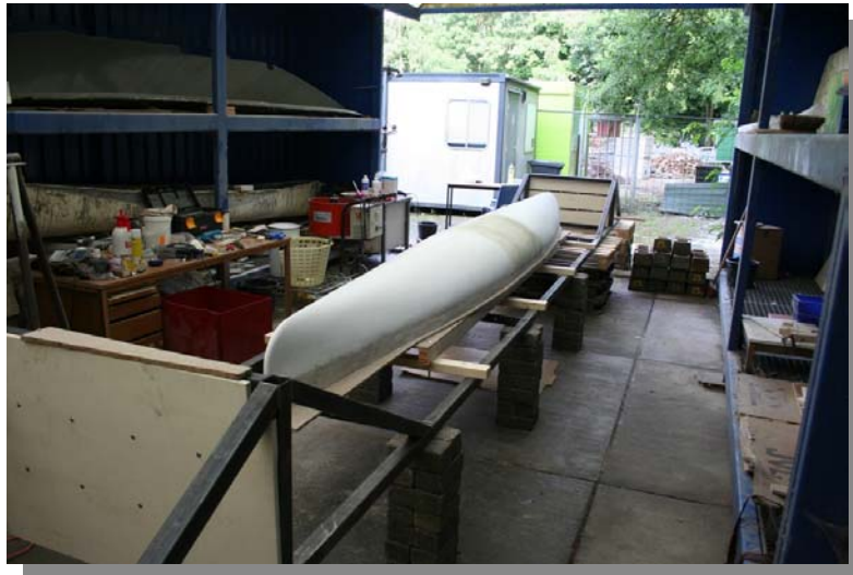
Figuur 13: De mal op de stalen constructie
