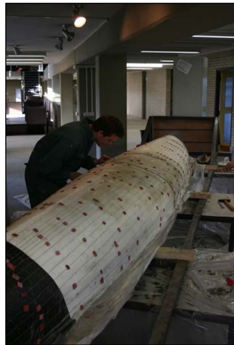
Figuur 14: Mal met kabels & afstandhouders
